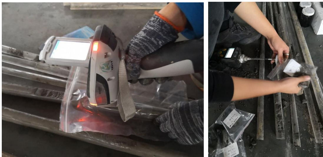
图 4.3-3 土壤现场快速检测情况
