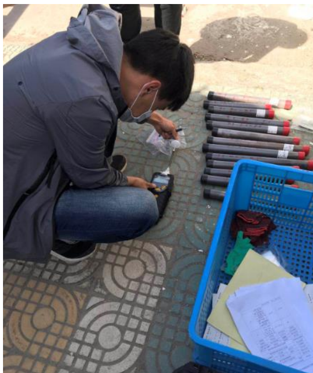
图 5.3-1 VOC 快速检测操作情况
