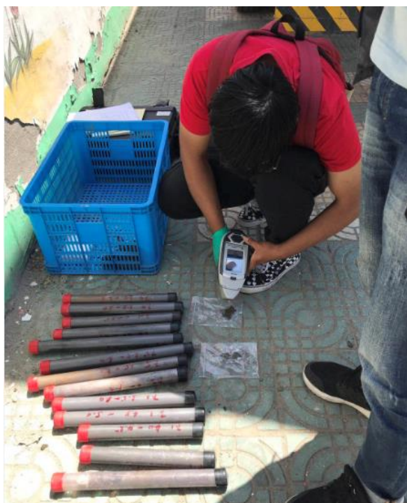
图 5.3-2 重金属快速检测操作情况
