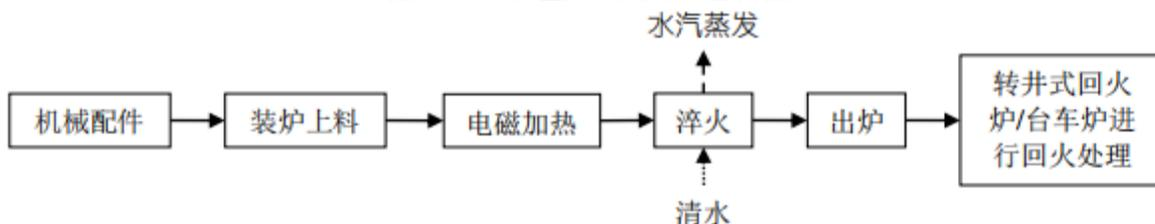
图 2.4-13 高频炉热处理工艺简图
