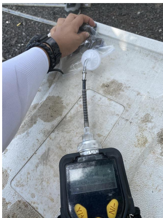
现场 PID 快速检测
