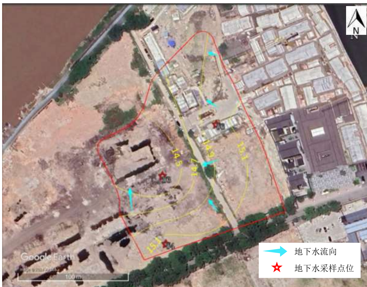
图 3.1-6 本地块初调工作地下水流向测绘图
