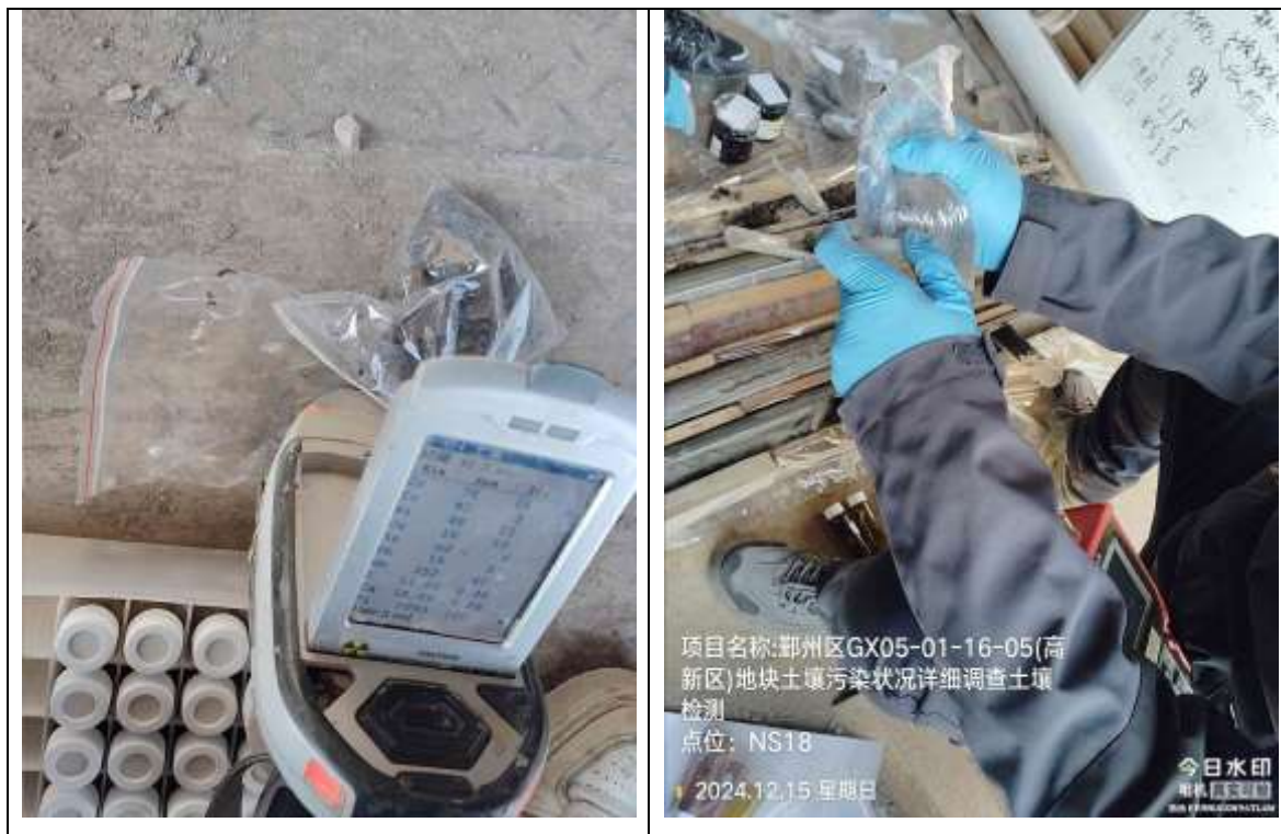
图 7.2-3 土壤现场快速检测情况
