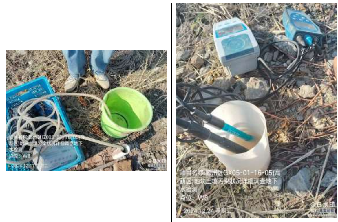
图 7.2-11 现场洗井、检测情况
